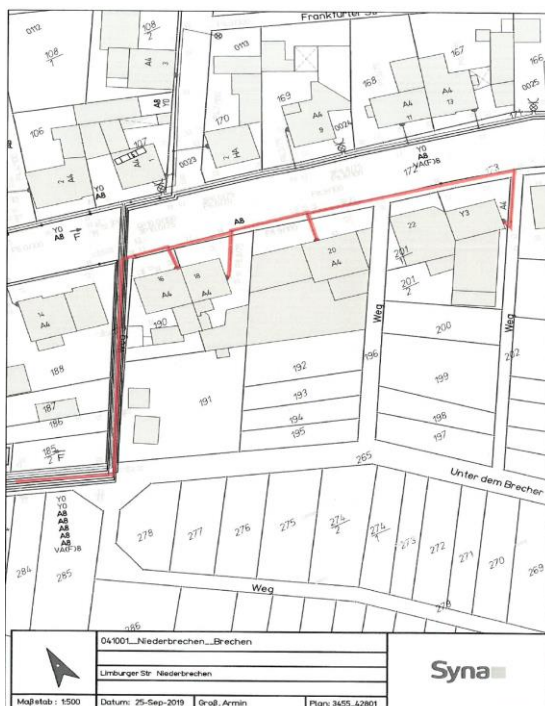
Mittel- und Niederspannungskabel
