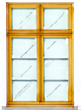
vierflügeliges Fenster mit Bleisprossen, profiliertem Kämpfer, Wetterschenkel und Schlagleiste
